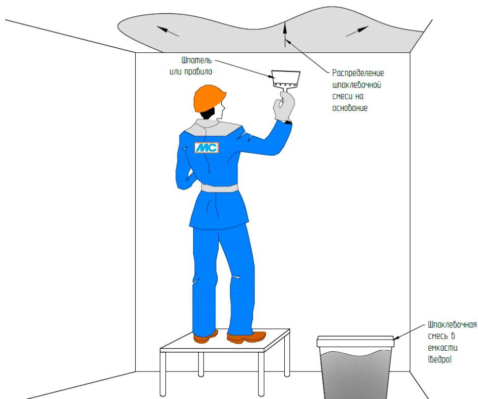
Рис. 11. Организация работ по нанесению шпаклевочной смеси
