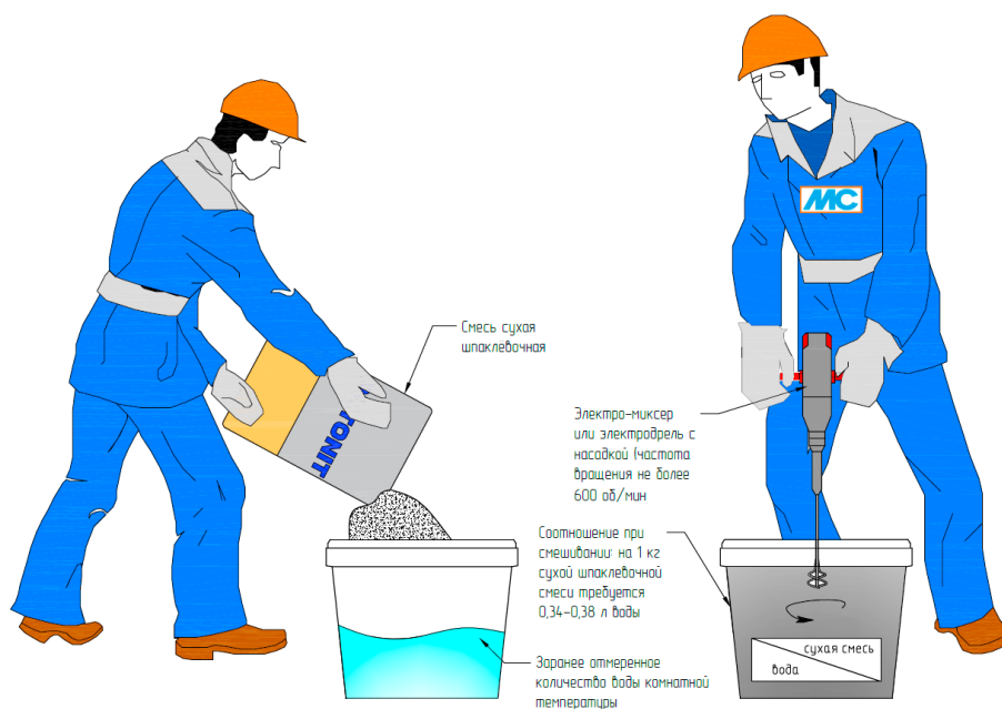
Рис. 10. Организация работ по затворению сухой шпаклевочной смеси
